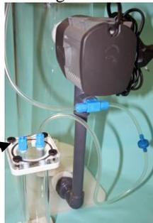
Co<sub>2</sub> Zuführung – Blasenzähler sollte mit destilliertem Wasser ca. bis zur Hälfte gefüllt werden (Algen)
