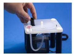
Zum Einsetzen der Düse ist darauf zu achten, dass die Bohrung in Kreisrichtung zeigt.
